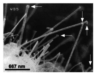
Fig. 10 SEM images of h-BN nanotubes.<sup>67</sup>
