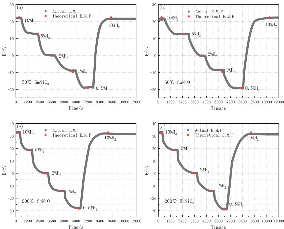
Fig. 7 Hydrogen sensing properties of  $\text{SmNiO}_3$  and  $\text{EuNiO}_3$  (a)  $50\text{ }^\circ\text{C-SmNiO}_3$  (b)  $50\text{ }^\circ\text{C-EuNiO}_3$  (c)  $200\text{ }^\circ\text{C-SmNiO}_3$  (d)  $200\text{ }^\circ\text{C-EuNiO}_3$ .
