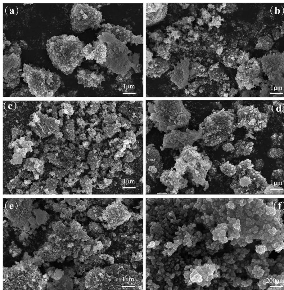
Fig. 8 SEM images of  $\text{Sm}_2\text{O}_3\text{-Ce-O}_x\text{@ZrO}_2$  catalysts with  $\text{Sm}_2\text{O}_3$  contents (a) 1%, (b) 2%, (c) 3%, (d) 4%, (e) 5%, (f) 5%–200 nm.
