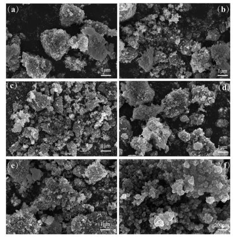
Fig. 8 SEM images of  $Sm_2O_3$ -Ce- $O_x$ @Zr $O_2$  catalysts with  $Sm_2O_3$  contents (a) 1%, (b) 2%, (c) 3%, (d) 4%, (e) 5%, (f) 5%–200 nm.
