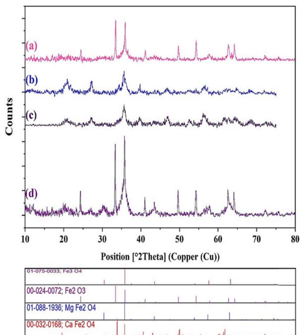
Fig. 3 XRD patterns of (a)  $\text{CaMgFe}_2\text{O}_4$  NPs; (b)  $\text{Fe}_3\text{O}_4@CS$  NPs; (c)  $\text{Fe}_3\text{O}_4@CS$ -Schiff base; and (d)  $\text{Fe}_3\text{O}_4@CS-SB-CaMgFe_2\text{O}_4$  nanocatalyst.
