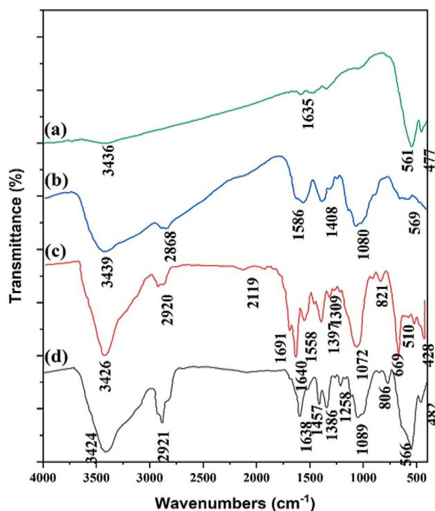
Fig. 2 FT-IR spectra of (a)  $\text{CaMgFe}_2\text{O}_4$  NPs; (b)  $\text{Fe}_3\text{O}_4@CS$  NPs; (c)  $\text{Fe}_3\text{O}_4@CS\text{-Schiff base}$ ; and (d)  $\text{Fe}_3\text{O}_4@CS\text{-SB-CaMgFe}_2\text{O}_4$  nanocatalyst.
