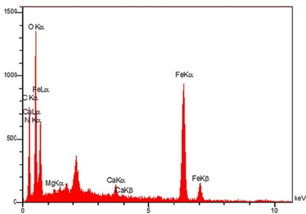
Fig. 6 EDX spectrum of the  $\text{Fe}_3\text{O}_4@CS-SB-CaMgFe_2\text{O}_4$  nanocatalyst.
