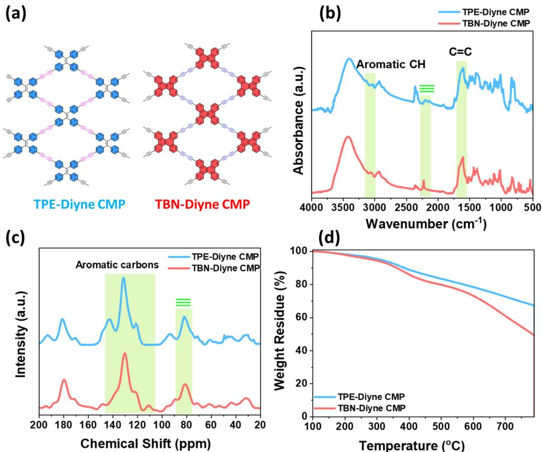
Fig. 2 (a) Molecular structures, (b) FTIR, (c) solid-state  $^{13}\text{C}$  NMR, and (d) TGA profiles of TPE-Diyne and TBN-Diyne CMPs.
