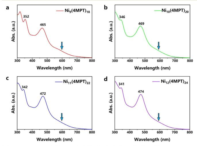
Fig. 3 UV-vis-NIR spectra of the  $Ni_n(4MPT)_{2n}$  clusters. (a)  $Ni_9(4MPT)_{18}$ . (b)  $Ni_{10}(4MPT)_{20}$ . (c)  $Ni_{11}(4MPT)_{22}$ . (d)  $Ni_{12}(4MPT)_{24}$ .
