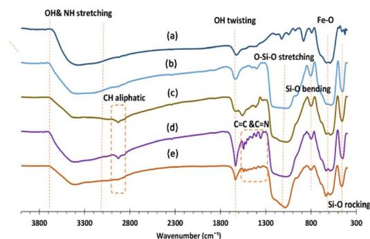
Fig. 1 FT-IR spectra of  $\text{Fe}_3\text{O}_4$  (a),  $\text{Fe}_3\text{O}_4@/\text{SiO}_2$  (b),  $\text{Fe}_3\text{O}_4@/\text{SiO}_2@/\text{PrNH}_2$  (c),  $\text{Fe}_3\text{O}_4@/\text{SiO}_2@/\text{PrNH}_2@2\text{OH}-1\text{NAP}$  (d), and  $\text{Fe}_3\text{O}_4@/\text{SiO}_2@/\text{Mn}$ -complex (e) MNPs.
