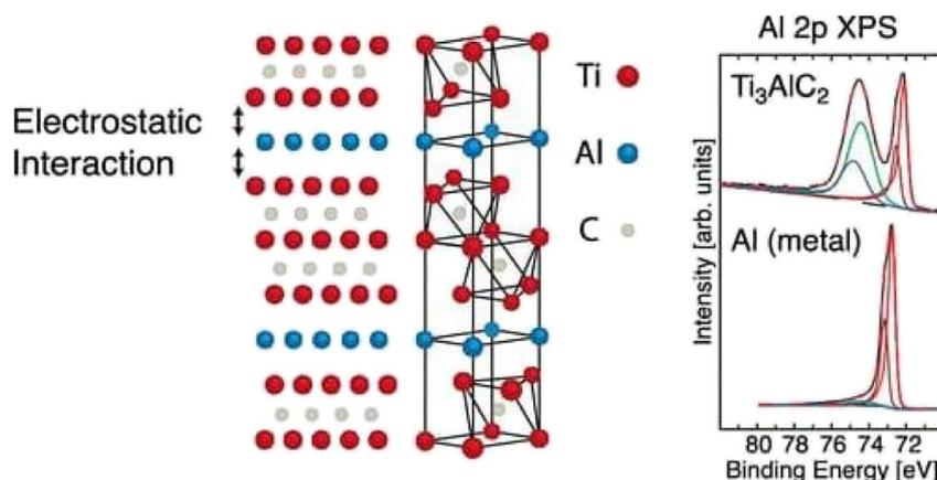
Fig. 6 X-ray photoelectron spectroscopy of  $\text{Ti}_3\text{AlC}_2$ .<sup>45</sup>
