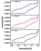
Fig. 3 Cyclic-voltammograms of DHBBI, DHBBI-OH, and DHBBI-2-OH.
