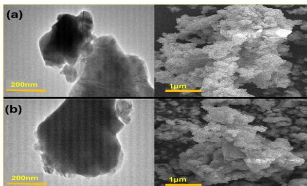
Fig. 2 SEM images for BGVO doped (a) 1%Tm<sup>3+</sup>/15%Yb<sup>3+</sup> and (b) 2%Er<sup>3+</sup>/1%Tm<sup>3+</sup>/15%Yb<sup>3+</sup>.
