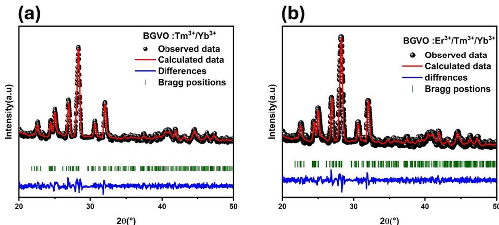
Fig. 1 (a) Rietveld refinement of XRD data of BGVO:1%Tm<sup>3+</sup>/15%Yb<sup>3+</sup> and (b) Rietveld refinement of XRD data of BGVO:2%Er<sup>3+</sup>/1%Tm<sup>3+</sup>/15%Yb<sup>3+</sup>.
