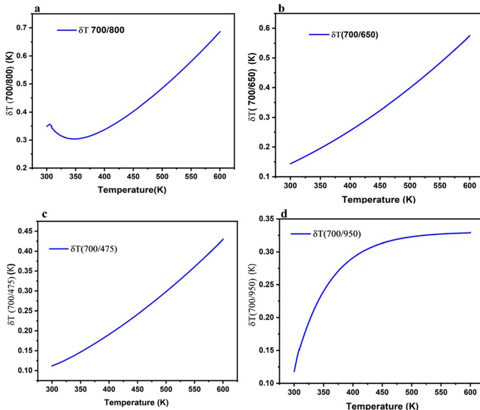
Fig. 10 Temperature uncertainty of BGVO:Tm<sup>3+</sup>/Yb<sup>3+</sup>, (a)  $\delta T(700/800)$  nm, (b)  $\delta T(700/650)$  nm, (c)  $\delta T(700/475)$  nm and (d)  $\delta T(700/950)$  under 975 nm.
