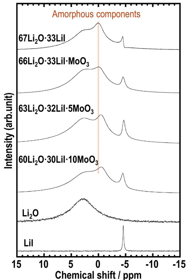
Fig. 4  ${}^7\text{Li}$  MAS-NMR spectra of  $67\text{Li}_2\text{O}\cdot 33\text{LiI}$ ,  $66\text{Li}_2\text{O}\cdot 33\text{LiI}\cdot \text{MoO}_3$ ,  $63\text{Li}_2\text{O}\cdot 32\text{LiI}\cdot 5\text{MoO}_3$ ,  $60\text{Li}_2\text{O}\cdot 30\text{LiI}\cdot 10\text{MoO}_3$ ,  $\text{Li}_2\text{O}$ , and  $\text{LiI}$ .
