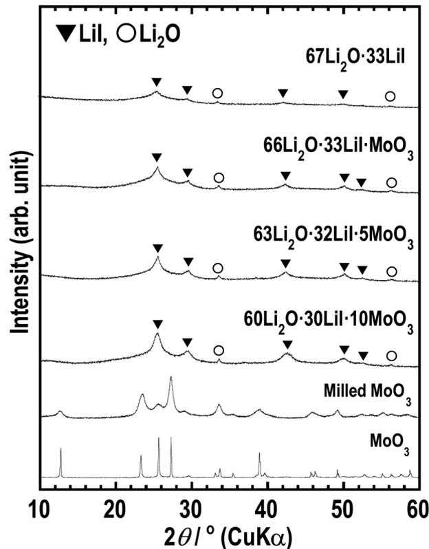
Fig. 1 XRD patterns of  $67\text{Li}_2\text{O}\cdot 33\text{LiI}$ ,  $66\text{Li}_2\text{O}\cdot 33\text{LiI}\cdot \text{MoO}_3$ ,  $63\text{Li}_2\text{O}\cdot 32\text{LiI}\cdot 5\text{MoO}_3$ ,  $60\text{Li}_2\text{O}\cdot 30\text{LiI}\cdot 10\text{MoO}_3$ , milled  $\text{MoO}_3$ , and  $\text{MoO}_3$ .
