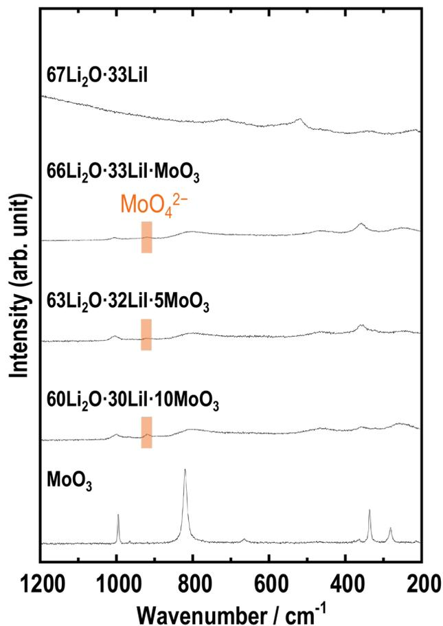
Fig. 3 Raman spectra of  $67\text{Li}_2\text{O}\cdot 33\text{LiI}$ ,  $66\text{Li}_2\text{O}\cdot 33\text{LiI}\cdot \text{MoO}_3$ ,  $63\text{Li}_2\text{O}\cdot 32\text{LiI}\cdot 5\text{MoO}_3$ ,  $60\text{Li}_2\text{O}\cdot 30\text{LiI}\cdot 10\text{MoO}_3$ , and  $\text{MoO}_3$ .
