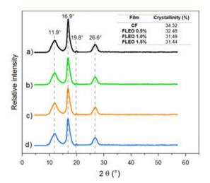
Fig. 3 XRD patterns of the films (a) CF (b) FLEO-0.5%, (c) FLEO-1.0% and (d) FLEO-1.5%
