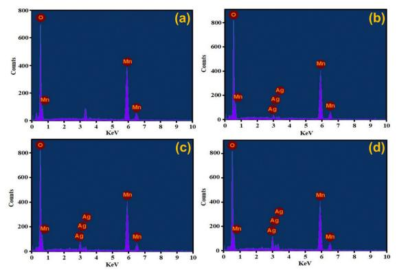
Fig. 6 EDX spectra of (a)  $MnO_2$ , (b)  $Ag_{0.05}MnO_2$ , (c)  $Ag_{0.10}MnO_2$ , (d)  $Ag_{0.15}MnO_2$
