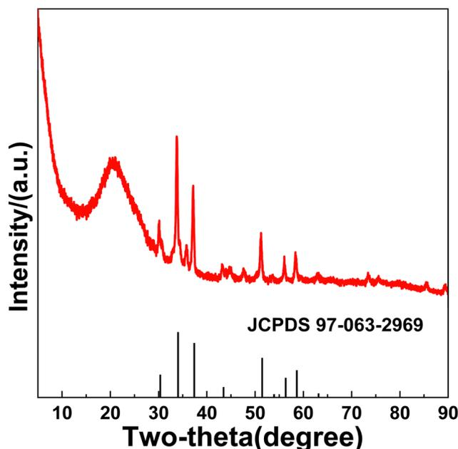
Fig. 3 XRD pattern of FeNiSe<sub>4</sub>@PG.
