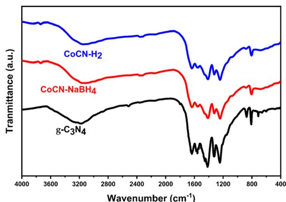
Fig. 4 FTIR spectra of  $\text{CoCN-H}_2$ ,  $\text{CoCN-NaBH}_4$ , and  $g\text{-C}_3\text{N}_4$ .
