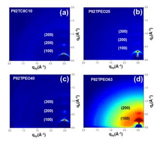
Fig. 6 2D GIXD patterns of (a) PII2TC8C10. (b) PII2TPEO25. (c) PII2TPEO40, and (d) PII2TPEO63, respectively
