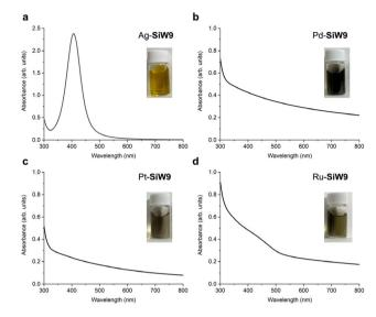
Fig. 2 UV-vis spectra and photos of the solutions of SiW9-modified metal nanoparticles: (a) Aq-SiW9, (b) Pd-SiW9, (c) Pt-SiW9, and (d) Ru-SiW9.
