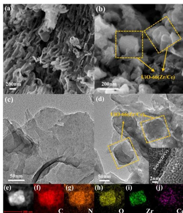
Fig. 5 SEM images of (a)  $g\text{-C}_3\text{N}_4$  and (b)  $g\text{-C}_3\text{N}_4/\text{UiO-66 (Zr/Ce)}$ ; TEM images of (c)  $g\text{-C}_3\text{N}_4$  and (d)  $g\text{-C}_3\text{N}_4/\text{UiO-66 (Zr/Ce)}$ ; (e–j) EDS mapping of  $g\text{-C}_3\text{N}_4/\text{UiO-66 (Zr/Ce)}$ .<sup>28</sup>
