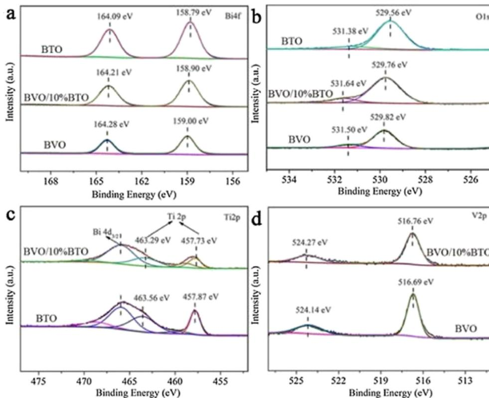
Fig. 9 The Bi 4f (a), O 1s (b), Ti 2p (c) and V 2p (d) spectra of  $\text{BiVO}_4$ ,  $\text{BiVO}_4/10\% \text{Bi}_4\text{Ti}_3\text{O}_{12}$  and  $\text{Bi}_4\text{Ti}_3\text{O}_{12}$ .<sup>52</sup>
