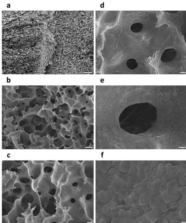
Fig. 4 Cross-sectional SEM images of a  $(\text{C}_6\text{H}_5\text{-CH}_2\text{-CH}_2\text{-NH}_3)_2\text{PbBr}_4$  aerogel. Scale bars: (a) 200  $\mu\text{m}$ , (b) 50  $\mu\text{m}$ , (c) 20  $\mu\text{m}$ , (d) 10  $\mu\text{m}$ , (e) 4  $\mu\text{m}$ , (f) 500 nm.
