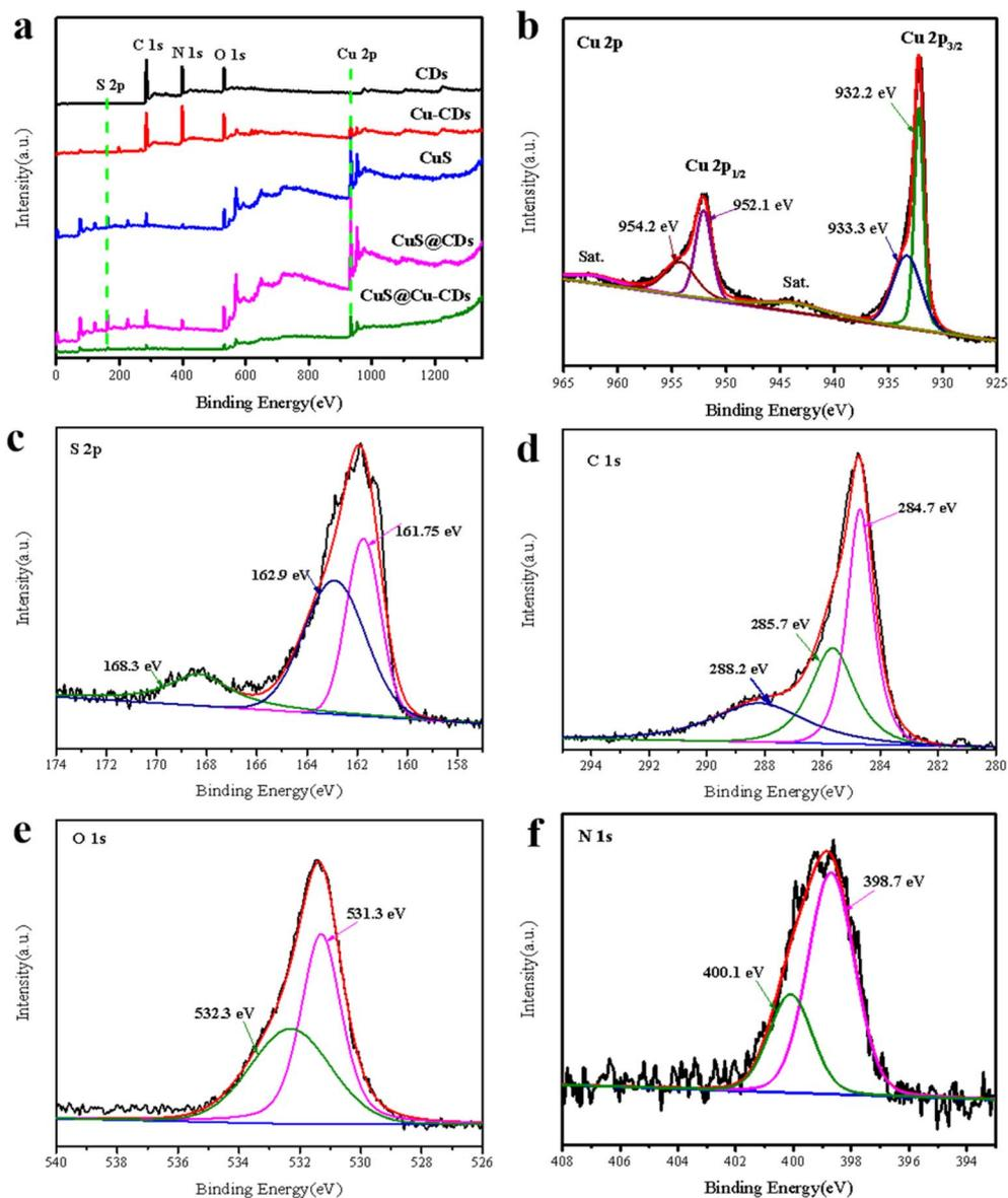
Fig. 4 XPS (a) survey spectrum (b) Cu 2p (c) S 2p (d) C 1s (e) O 1s (f) N 1s.
