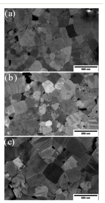
Fig. 8 Microstructure of (a)  $SC_{900}$ , (b)  $NC_{900}$ , and (d)  $Q_{900}$  KBT ceramics.
