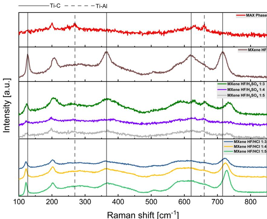
Fig. 3 Raman spectra of MAX phase, MXene HF, MXenes HF/H<sub>2</sub>SO<sub>4</sub> 1 : 3, 1 : 4, 1 : 5 and MXenes HF/HCl 1 : 3, 1 : 4, 1 : 5.
