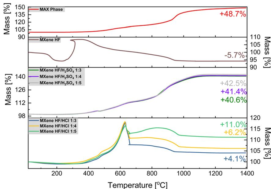
Fig. 4 TGA curves of MAX phase, MXene HF, MXenes HF/H<sub>2</sub>SO<sub>4</sub> 1 : 3, 1 : 4, 1 : 5 and MXenes HF/HCl 1 : 3, 1 : 4, 1 : 5.
