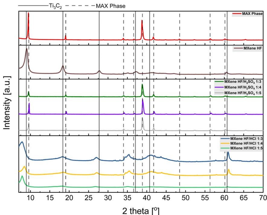
Fig. 2 XRD patterns of MAX phase, MXene HF, MXenes HF/H<sub>2</sub>SO<sub>4</sub> 1 : 3, 1 : 4, 1 : 5 and MXenes HF/HCl 1 : 3, 1 : 4, 1 : 5.
