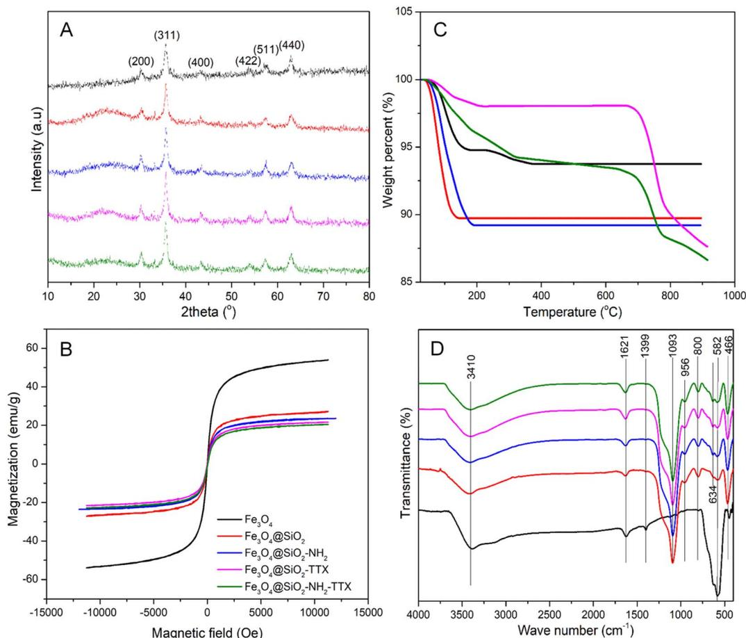
Fig. 1 Characteristics of  $\text{Fe}_3\text{O}_4$ ,  $\text{Fe}_3\text{O}_4@SiO_2$ ,  $\text{Fe}_3\text{O}_4@SiO_2-NH_2$ ,  $\text{Fe}_3\text{O}_4@SiO_2-TTX$ ,  $\text{Fe}_3\text{O}_4@SiO_2-NH_2-TTX$ . XRD (A), VSM (B), TGA (C), and FT-IR (D).
