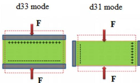
Fig. 5 The piezoelectric  $d_{33}$  and  $d_{31}$  modes.<sup>20</sup>
