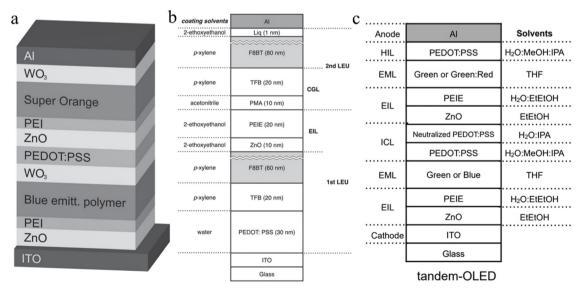
Fig. 10 Solution-processed OLEDs. (a) Inverted tandem OLED. 169 Copyright 2014 Wiley-VCH Verlag GmbH & Co. KGaA, Weinheim. (b) Positive tandem OLED<sup>170</sup> (Copyright 2014 Wiley-VCH Verlag GmbH & Co. KGaA, Weinheim) and (c) phosphorescent tandem OLED.<sup>69</sup> Copyright 2015 Wiley-VCH Verlag GmbH & Co. KGaA, Weinheim.
