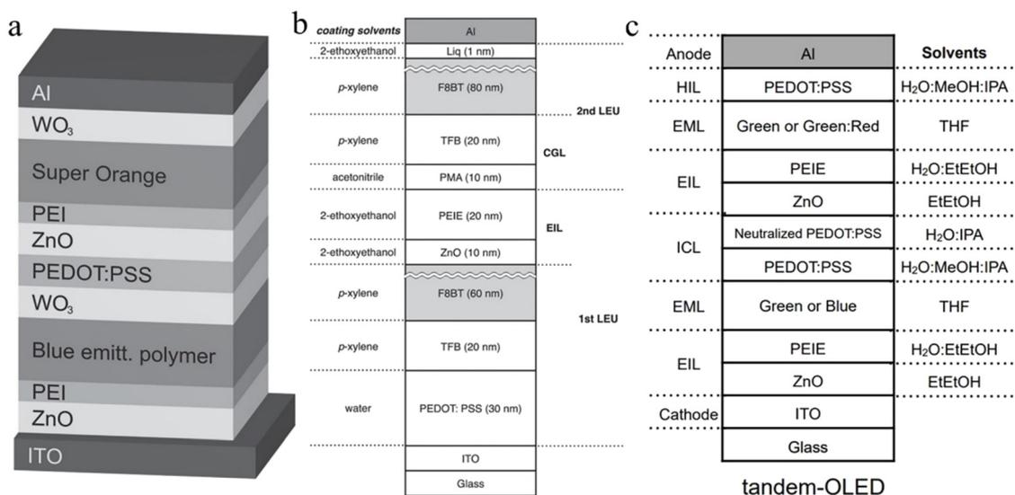
Fig. 10 Solution-processed OLEDs. (a) Inverted tandem OLED.<sup>169</sup> Copyright 2014 Wiley-VCH Verlag GmbH & Co. KGaA, Weinheim. (b) Positive tandem OLED<sup>170</sup> (Copyright 2014 Wiley-VCH Verlag GmbH & Co. KGaA, Weinheim) and (c) phosphorescent tandem OLED.<sup>69</sup> Copyright 2015 Wiley-VCH Verlag GmbH & Co. KGaA, Weinheim.
