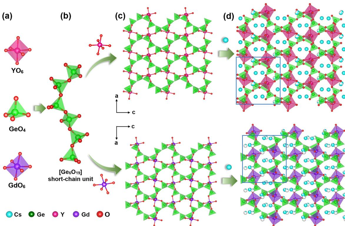
Fig. 2 (a) Structural motifs  $[Ge_4]$ ,  $[YO_6]$ ,  $[GdO_6]$  of  $Cs_3REGe_3O_9$ ; (b)  $[Ge_6O_{19}]$  short-chain unit; (c) quasi-planar structures of  $Cs_3REGe_3O_9$  paralleled to the  $ac$  plane, and (d) 3D framework structure of  $Cs_3REGe_3O_9$ .
