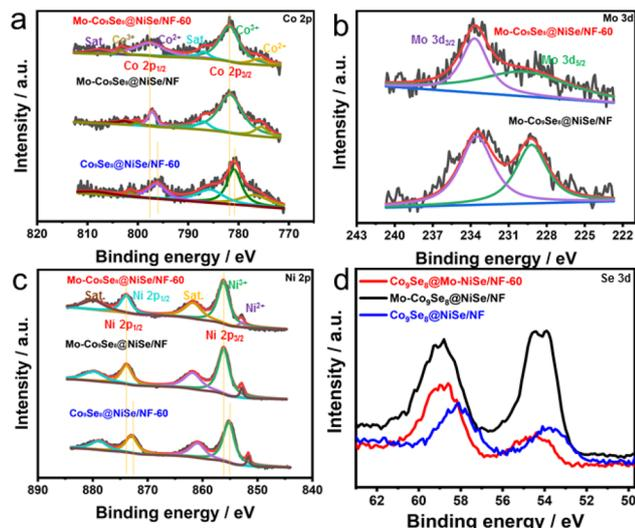
Fig. 4 High-resolution XPS spectra of (a) Co 2p, (b) Mo 3d, (c) Ni 2p, and (d) Se 3d in Mo-Co<sub>9</sub>Se<sub>8</sub>@NiSe/NF-60, Mo-Co<sub>9</sub>Se<sub>8</sub>@NiSe/NF, and Co<sub>9</sub>Se<sub>8</sub>@NiSe/NF-60.
