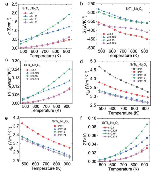
Fig. 4 Thermoelectric performance of  $SrTi_{1-x}Nb_xO_3$  (x=0-0.175): (a)  $\sigma$ ; (b) S; (c) PF; (d)  $\kappa_{tot}$ ; (e)  $\kappa_{lat}$ ; (f) ZT.
