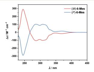
Fig. 9 ECD spectra of (M)-6-Mes and (P)-6-Mes in  $CH_2Cl_2$  ( $c=2.2 \times 10^{-6}$  $10^{-5}$  – 2.5  $\times$  10<sup>-5</sup> M) at 20 °C.
