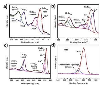
Fig. 2 XPS spectra of CoMn-LDH@CuO/Cu<sub>2</sub>O; (a) Co 2p (b) Mn 2p (c) Cu 2p (d) O 1s.
