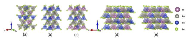
Fig. 1 Crystal structures for  $CuZn_2InSe_4$  with (a) kesterite (KS), (b) primitive mixed CuAu (PMCA), (c) stannite (ST), (d) wurtzite-kesterite (WKS), (e) wurtzite-stannite (WST) phases.
