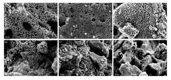
Fig. 2 SEM images of (a) LaMnO<sub>3</sub>, (b) La<sub>0.9</sub>Ce<sub>0.1</sub>MnO<sub>3</sub>, (c) La<sub>0.9</sub>Ce<sub>0.1</sub>Mn<sub>0.9</sub>Cu<sub>0.05</sub>O<sub>3</sub> and (d) La<sub>0.9</sub>Ce<sub>0.1</sub>Mn<sub>0.9</sub>Cu<sub>0.1</sub>O<sub>3</sub>, (e) La<sub>0.9</sub>Ce<sub>0.1</sub>Mn<sub>0.8</sub>Cu<sub>0.2</sub>O<sub>3</sub>, (f) La<sub>0.9</sub>Ce<sub>0.1</sub>Mn<sub>0.6</sub>Cu<sub>0.4</sub>O<sub>3</sub>.
