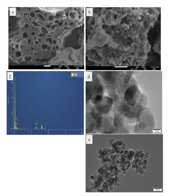
Fig. 1 SEM, TEM, EDS, and HRTEM of CBc and  $Fe_3O_4/CBc$ . (a) CBc SEM. (b)  $Fe_3O_4/CBc$  SEM. (c)  $Fe_3O_4/CBc$  EDS. (d)  $Fe_3O_4/CBc$  TEM. (e)  $Fe_3O_4/CBc$  CBc HRTEM.
