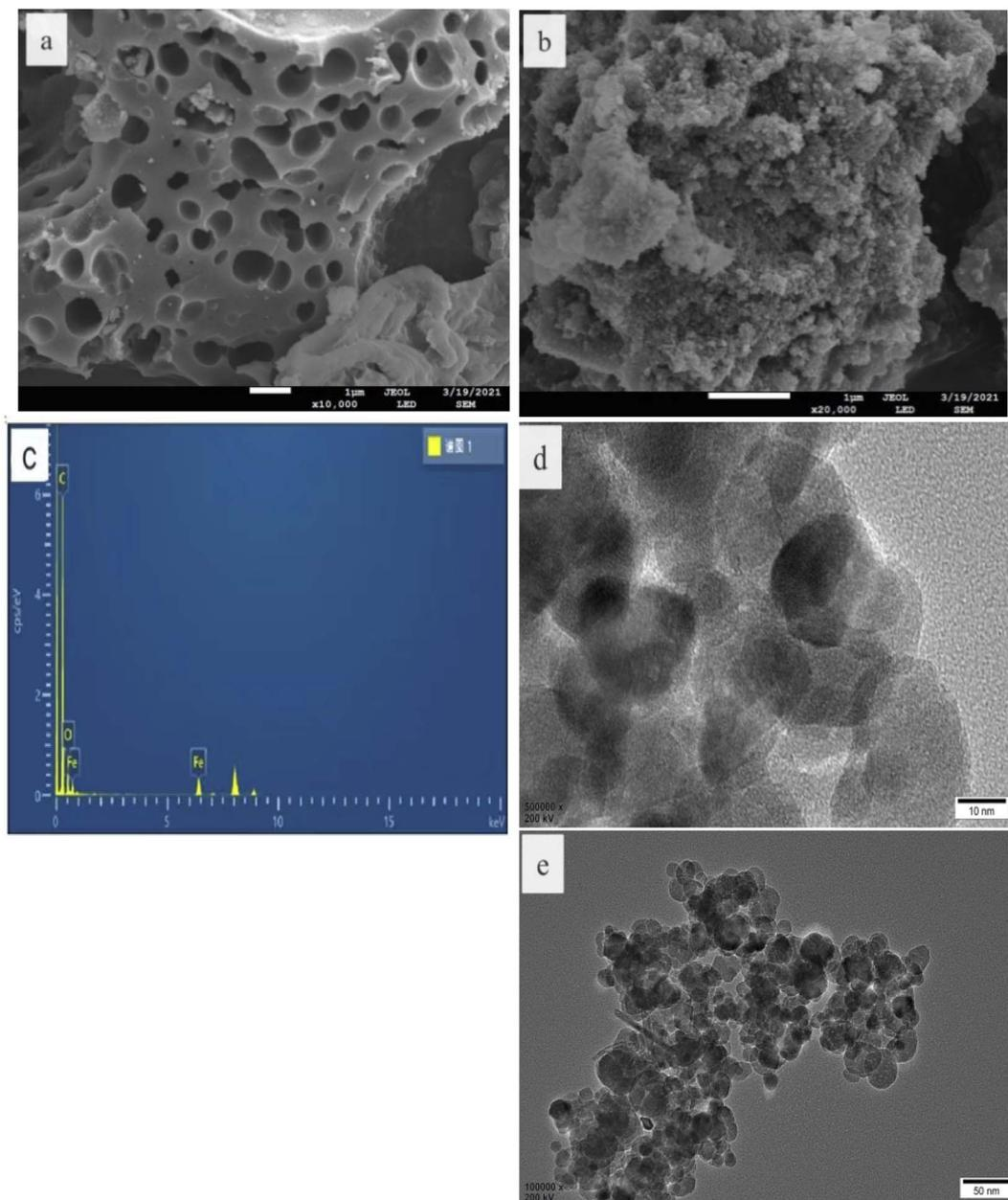
Fig. 1 SEM, TEM, EDS, and HRTEM of CBc and Fe<sub>3</sub>O<sub>4</sub>/CBc. (a) CBc SEM. (b) Fe<sub>3</sub>O<sub>4</sub>/CBc SEM. (c) Fe<sub>3</sub>O<sub>4</sub>/CBc EDS. (d) Fe<sub>3</sub>O<sub>4</sub>/CBc TEM. (e) Fe<sub>3</sub>O<sub>4</sub>/CBc HRTEM.
