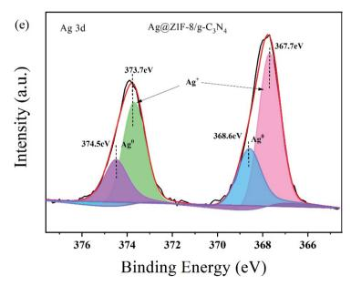
Fig. 5 XPS spectra of (a) Ag@ZIF-8/g- $C_3N_4$ , (b) C 1s, (c) N 1s (d) Zn 2p (e) Ag 3d.
