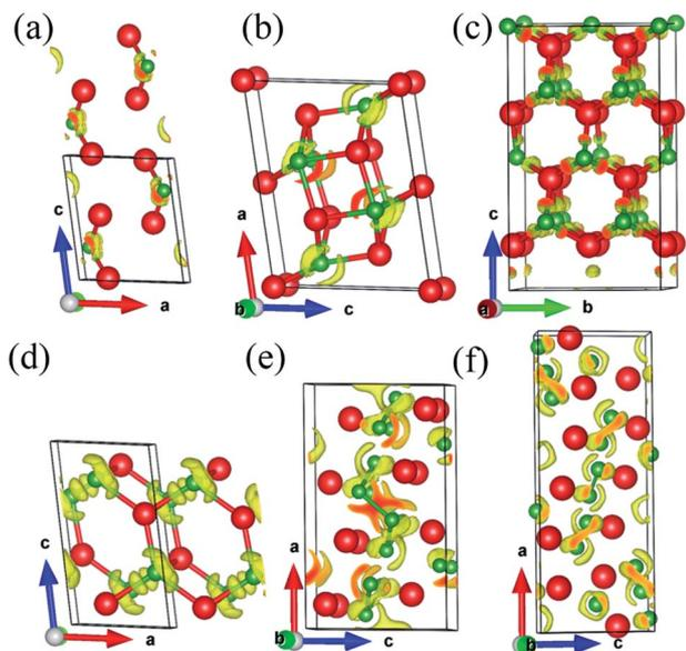
Fig. 6 ELFs of the (a)  $P2_1/m$ - $\text{Ir}_2\text{B}$ , (b)  $C2/m$ - $\text{Ir}_3\text{B}_2$ , (c)  $Fmm2$ - $\text{Ir}_4\text{B}_3$  (d)  $P2_1/m$ - $\text{IrB}$ , (e)  $Cm$ - $\text{Ir}_4\text{B}_5$  and (f)  $Pnma$ - $\text{Ir}_3\text{B}_4$  (isovalue = 0.65).
