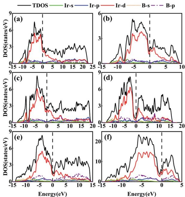
Fig. 5 Calculated electronic density of states for (a)  $P2_1/m$ - $\text{Ir}_2\text{B}$ , (b)  $C2/m$ - $\text{Ir}_3\text{B}_2$ , (c)  $Fmm2$ - $\text{Ir}_4\text{B}_3$ , (d)  $P2_1/m$ - $\text{IrB}$ , (e)  $Cm$ - $\text{Ir}_4\text{B}_5$  and (f)  $Pnma$ - $\text{Ir}_3\text{B}_4$  under atmospheric pressure.
