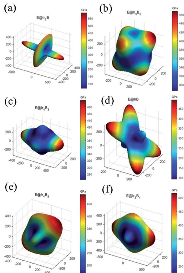
Fig. 4 Three-dimensional Young's modulus for (a)  $P2_1/m$ - $\text{Ir}_2\text{B}$ , (b)  $C2/m$ - $\text{Ir}_3\text{B}_2$ , (c)  $Fmm2$ - $\text{Ir}_4\text{B}_3$ , (d)  $P2_1/m$ - $\text{IrB}$ , (e)  $Cm$ - $\text{Ir}_4\text{B}_5$  and (f)  $Pnma$ - $\text{Ir}_3\text{B}_4$  under ambient pressure.
