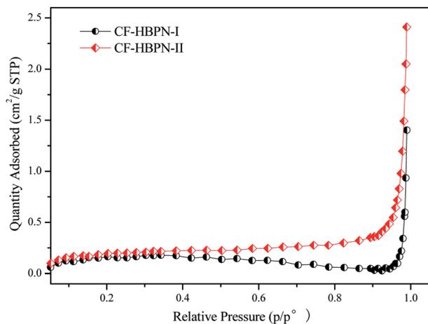
Fig. 3 N<sub>2</sub> adsorption isotherms of CF-HBPN-I and CF-HBPN-II.
