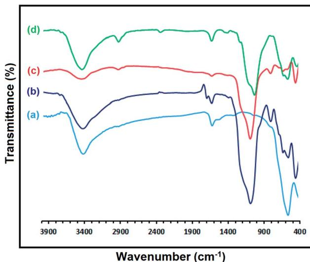
Fig. 2 FT-IR spectra of the (a)  $\text{Fe}_3\text{O}_4$ , (b)  $\text{Fe}_3\text{O}_4@\text{SiO}_2@\text{KCC-1}$ , (c)  $\text{Fe}_3\text{O}_4@\text{SiO}_2@\text{KCC-1}@MPTMS$ , and (d)  $\text{Fe}_3\text{O}_4@\text{SiO}_2@\text{KCC-1}@MPTMS@Cu^{II}$  nanosystems.
