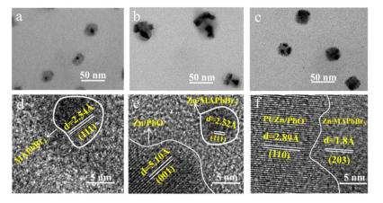
Fig. 1 Morphological characterization. TEM images of (a) PbO/PC-MAPbBr<sub>3</sub>, (b) Zn/PbO/PC-Zn/MAPbBr<sub>3</sub> and (c) Pt<sup>IV</sup>/Zn/PbO/PC-Zn/MAPbBr<sub>3</sub>. HRTEM images of (d) PbO/PC-MAPbBr<sub>3</sub>, (e) Zn/PbO/PC-Zn/MAPbBr<sub>3</sub> and (f) Pt<sup>IV</sup>/Zn/PbO/PC-Zn/MAPbBr<sub>3</sub>.
