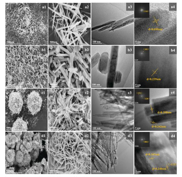
The SEM and TEM images of (a)  $\alpha$ -, (b)  $\beta$ -, (c)  $\gamma$ - and (d)  $\delta$ -MnO<sub>2</sub>
