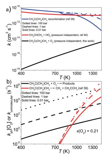
Fig. 10 The high-temperature kinetics of the  $CH_2C(CH_3)CH_2^{\bullet} + O_2$  reaction compared with the kinetics of the reactions (a)  $CH_2C(CH_3)CH_2^{\bullet} + CH_2C(CH_3)CH_2^{\bullet} \rightarrow CH_2C(CH_3)CH_2CH_2C(CH_3)CH_2$  and  $CH_2CH_2CH_2^{\bullet} + HO_2^{\bullet} \rightarrow Products$  and (b)  $CH_2C(CH_3)CH_2^{\bullet} \rightarrow CH_3^{\bullet} + CH_2CCH_2$ .
