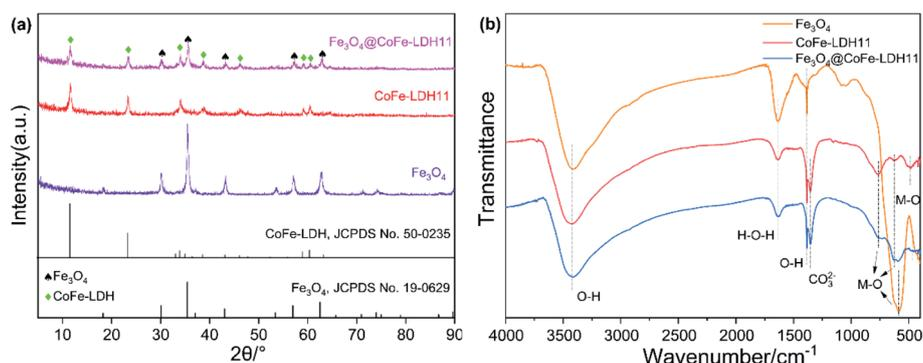
Fig. 2 XRD patterns (a) and FT-IR spectra (b) of bare  $\text{Fe}_3\text{O}_4$ , raw CoFe-LDH11 and  $\text{Fe}_3\text{O}_4@\text{CoFe-LDH11}$ .
