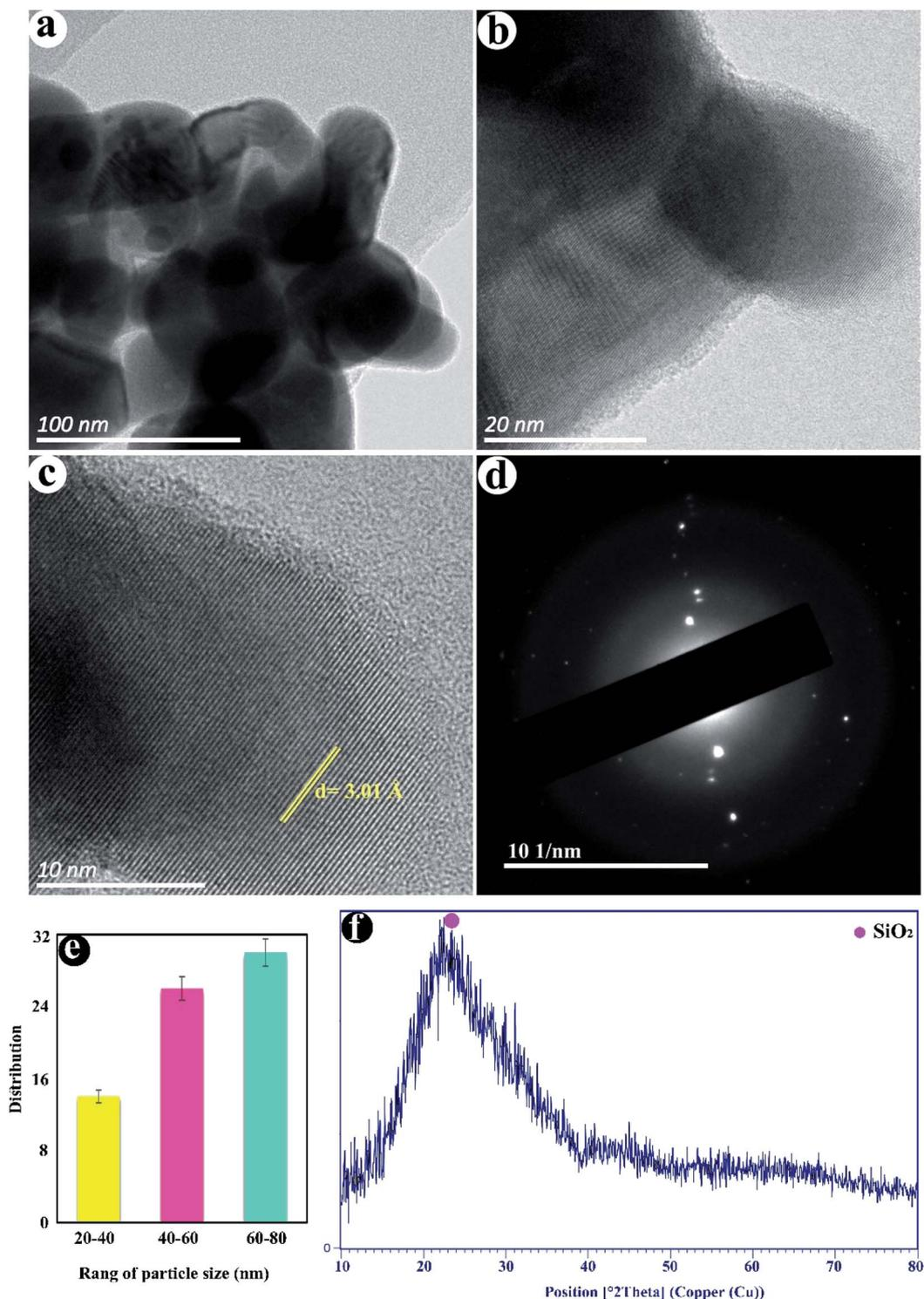
Fig. 2 (a–c) TEM images, (d) SAED, (e) size distribution, and (f) XRD pattern of SiO<sub>2</sub> NPs.
