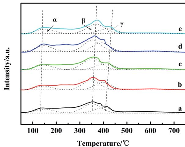
Fig. 5  $\text{NH}_3$ -TPD spectrum of catalysts with different  $\text{Ga}_2\text{O}_3$  contents: (a)  $\text{CZG}_0\text{H}$ ; (b)  $\text{CZG}_1\text{H}$ ; (c)  $\text{CZG}_3\text{H}$ ; (d)  $\text{CZG}_5\text{H}$ ; (e)  $\text{CZG}_{10}\text{H}$ .
