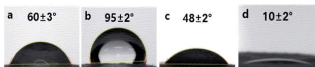
Fig. 4 Contact angle of PK micro/nano fiber membranes; (a) PK-LH, (b) PK-HH, (c) PK-NaCl, (d) rPK-NaCl.
