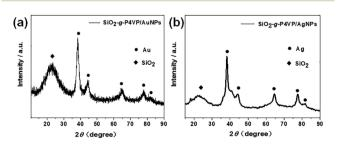
Fig. 4 XRD patterns of (a)  $SiO_2$ -g-P4VP/AuNPs and (b)  $SiO_2$ -g-P4VP/AgNPs.
