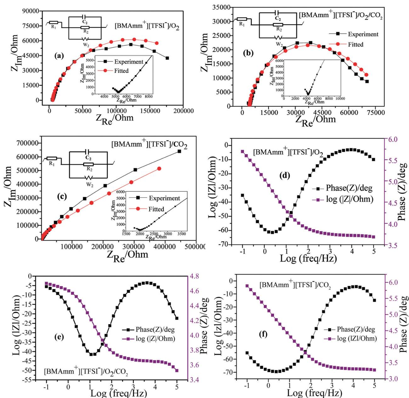
Fig. 6 Nyquist plots detected in (a)  $O_2$ -saturated-[BMAMm<sup>+</sup>][TFSI<sup>-</sup>], (b)  $O_2/CO_2$ -saturated-[BMAMm<sup>+</sup>][TFSI<sup>-</sup>] and (c)  $CO_2$ -saturated-[BMAMm<sup>+</sup>][TFSI<sup>-</sup>]. Bode plots detected in (d)  $O_2$ -saturated-[BMAMm<sup>+</sup>][TFSI<sup>-</sup>], (e)  $O_2/CO_2$ -saturated-[BMAMm<sup>+</sup>][TFSI<sup>-</sup>] and (f)  $CO_2$ -saturated-[BMAMm<sup>+</sup>][TFSI<sup>-</sup>].
