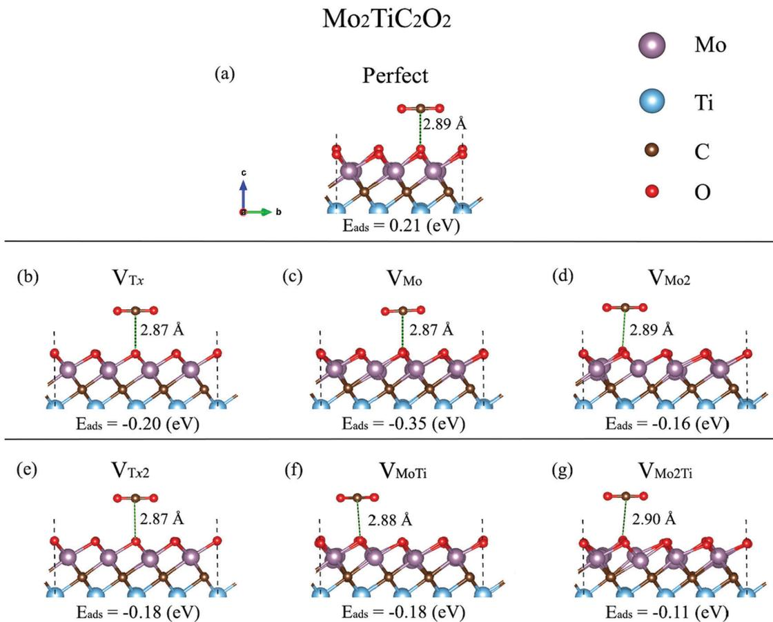
Fig. 5 Relaxed adsorption configurations of a  $\text{CO}_2$  molecule on the perfect and defected  $\text{Mo}_2\text{TiC}_2\text{O}_2$  MXene. (a) Perfect MXene, (b) MXene- $V_{\text{Tx}}$ , (c) MXene- $V_{\text{Mo}}$ , (d) MXene- $V_{\text{Mo}_2}$ , (e) MXene- $V_{\text{Tx}_2}$ , (f) MXene- $V_{\text{MoTi}}$ , and (g) MXene- $V_{\text{Mo}_2\text{Ti}}$ .
