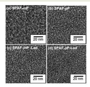
Fig. 2 TEM images of (a) SPAF-mP, (b) SPAF-pP, (c) SPAF-mP-Lad and (d) SPAF-pP-Lad membranes stained with Pb<sup>2+</sup> ions.
