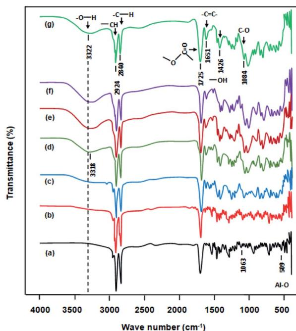
Fig. 1 FTIR spectra of: (a) pure PVA, (b) CPVA, (c) CPVA/Na<sup>+</sup>MMT1, (d) CPVA/Na<sup>+</sup>MMT5, (e) CPVA/Na<sup>+</sup>MMT10, (f) CPVA/Na<sup>+</sup>MMT15, (g) CPVA/Na<sup>+</sup>MMT20 nanocomposites.
