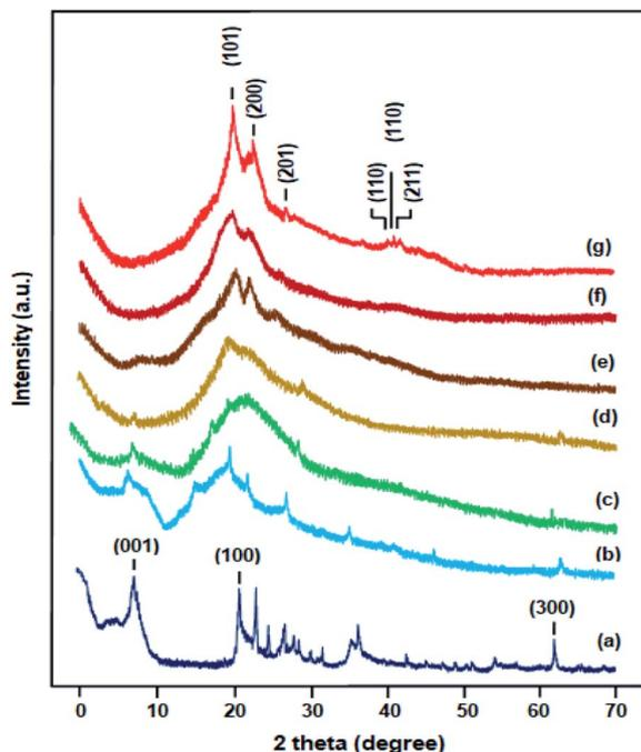
Fig. 2 XRD spectra of: (a) MMT, (b) pure PVA, (c) CPVA, (d) CPVA/Na<sup>+</sup>MMT1, (e) CPVA/Na<sup>+</sup>MMT5, (f) CPVA/Na<sup>+</sup>MMT10, (g) CPVA/Na<sup>+</sup>MMT15.
