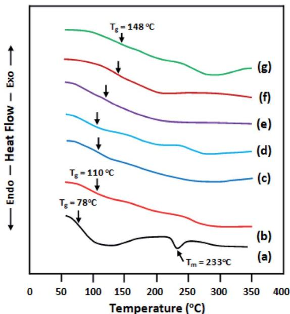
Fig. 4 DSC thermograms of: (a) pure PVA; (b) CPVA; (c) CPVA/Na<sup>+</sup>MMT1; (d) CPVA/Na<sup>+</sup>MMT5; (e) CPVA/Na<sup>+</sup>MMT10; (f) CPVA/Na<sup>+</sup>MMT15; (g) CPVA/Na<sup>+</sup>MMT20 nanocomposite membranes.
