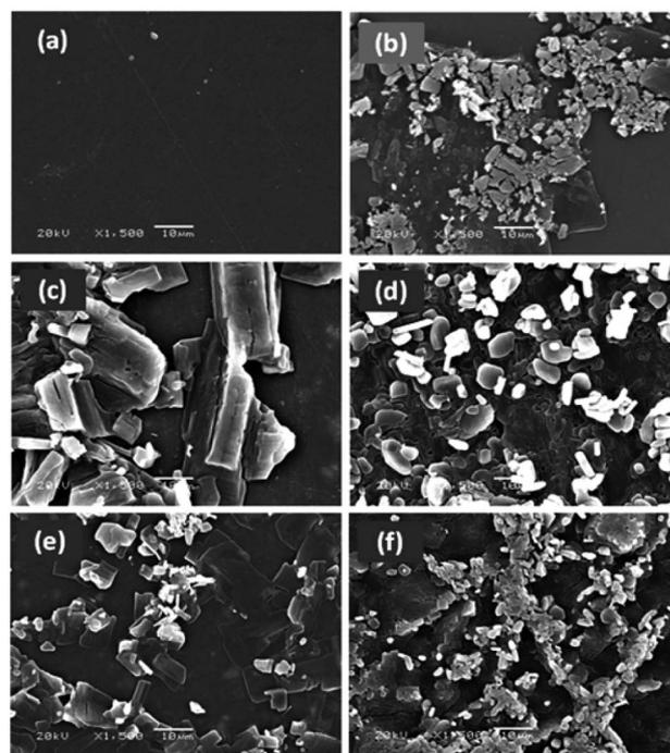
Fig. 3 SEM micrographs of: (a) pure PVA; (b) CPVA; (c) CPVA/Na<sup>+</sup>MMT5; (d) CPVA/Na<sup>+</sup>MMT10; (e) CPVA/Na<sup>+</sup>MMT15; (f) CPVA/Na<sup>+</sup>MMT20 nanocomposite membranes.
