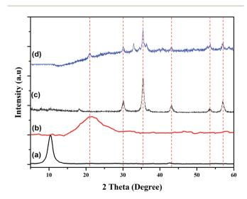
Fig. 5 Powder XRD patterns of (a) GO, (b) rGO, (c) Fe $_3$ O $_4$  NPs and (d) rGO/Fe $_3$ O $_4$  NCs.
