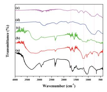
Fig. 3 FT-IR spectrum of (a) pod extract of Dolichos lablab L., (b) GO, (c) rGO, (d) Fe<sub>3</sub>O<sub>4</sub> NPs and (e) rGO/Fe<sub>3</sub>O<sub>4</sub> NCs.
